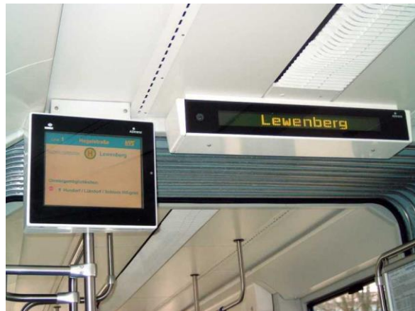
Fahrgastfernsehen und Innenanzeige am ersten Gelenk in einer Straßenbahn vom Typ SN 2001. Foto: Axel Aurich (03.02.07)
