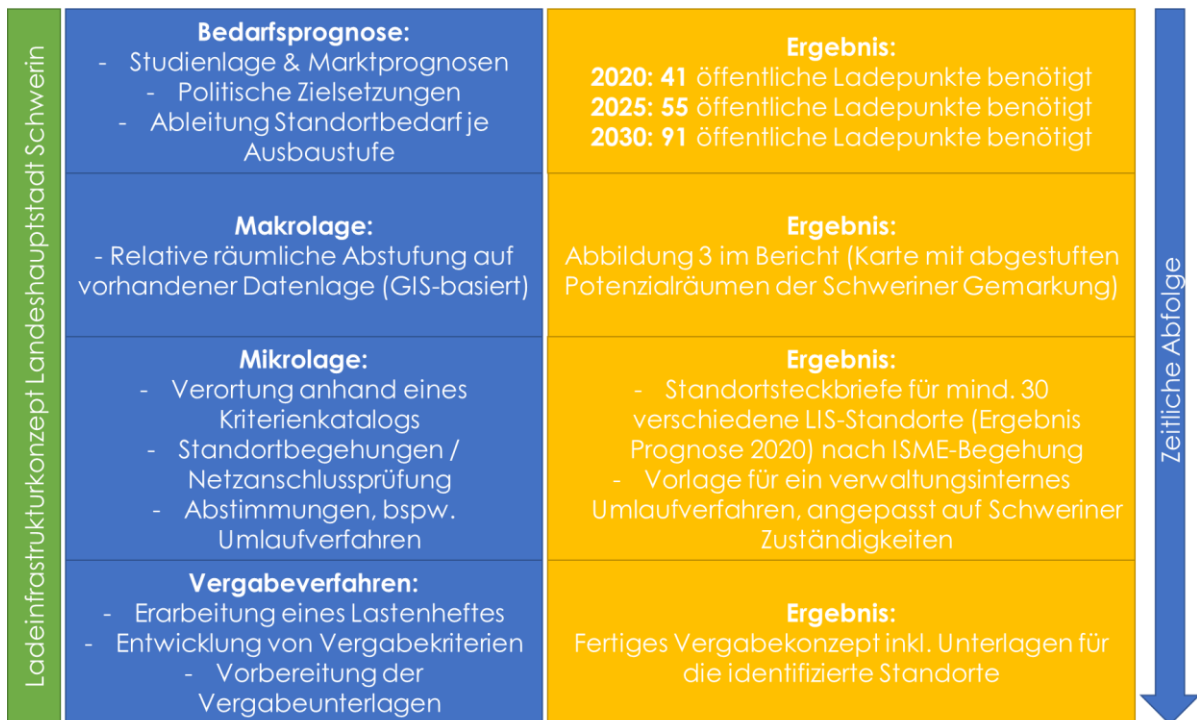
Abbildung 2: Schematische Darstellung des Ladeinfrastrukturkonzeptes der Landeshauptstadt Schwerin (Quelle: Eigene Darstellung)
